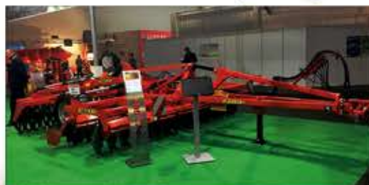
Čerstvou novinkou jsou polonesené verze Pegas II SM, jejichž řada zahrnuje tři modely s pracovním lůžkami 4; 5 a 6 m a s těmi nejmenšími je možné agregovat traktor o výkonu 150 koní.
