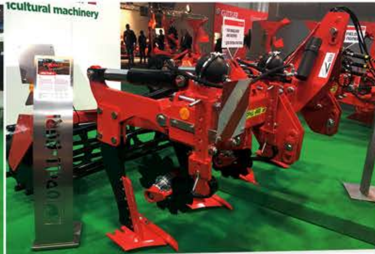
Hloubkový kyprčák Hektor I je stroj určený k podjourní vrstvy ornice a podmiřiči. Jeho prací je půdu podříznout, ale nezamíchat. Přímou u expozici byl Hektor upraven pro práci na trvalých travních porostech
