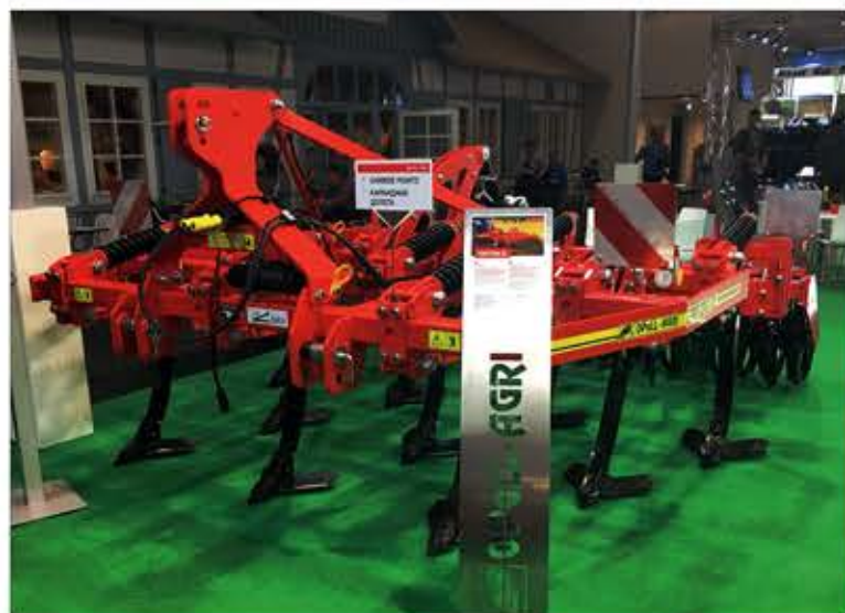
Triřadý radičkový kyprčák Triton II byl rovněž k vidění na stánku na výstavě Agritechnica. Univerzální radičkový kyprčák umožňuje kyprění v různých hloubkách od 8 do 28 cm a s různou intenzitou prokyprění
