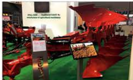
Pluh Orion je tvořen stavebnicovým systémem rámu, takže umožňuje měnit počet radlic. V základu je šest radlic a stroj může být po jedné rozšířen až o tři radlice. OpaLL Agri s. r. o. se může pochlubit i novou rodinou pluhů, které dostaly označení Apollo a premiéru budou mít na Techagru
