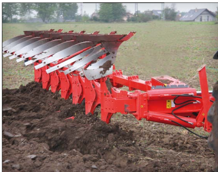
Páskové orební těleso PA400 se vyznačuje výborným drobením půdy
